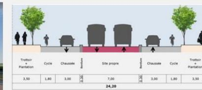
Un profil type de BHNS avec une voie bus dans chaque sens ou « site propre bidirectionnel »
