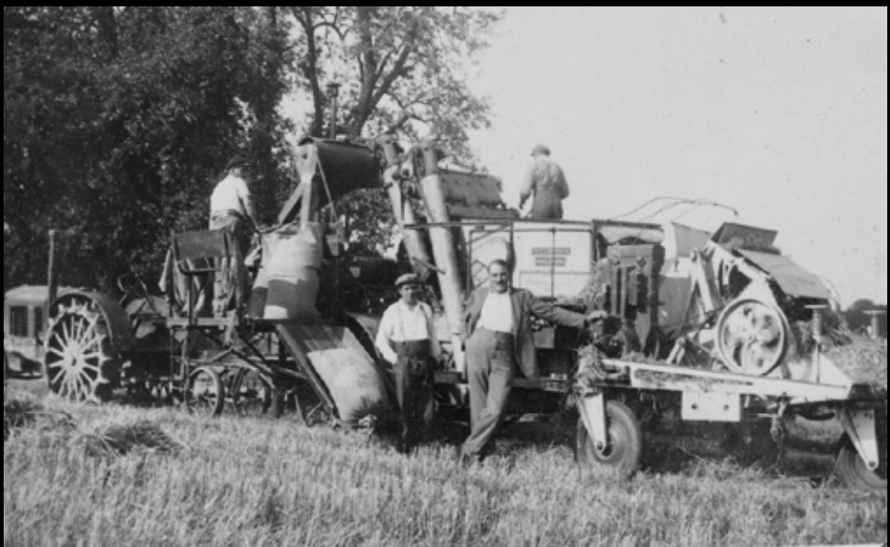
Attainville. Ferme Vanderhaeghe. Moissonneuse F8 Eclair tractée McComick avec plateau d'ensilage. Vers 1930-1940 .
