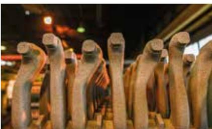
**Fig.49.** Une série de noyaux de fonderie dédiés à la fabrication de pièces de moteurs en aluminium (photographie communiquée par l'entreprise Montupet : Montupet Linamar - Light Metal Casting).
