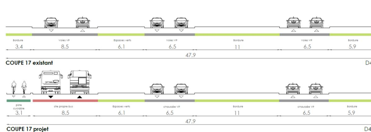
Figure 74 : profils existant et projeté sur la RD88 entre le giratoire Hyatt et la rue de la Belle Borne
