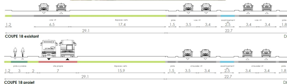
Figure 75 profils existant et projeté sur la RD88 entre la rue de la Belle Borne et la rue du Fortin
